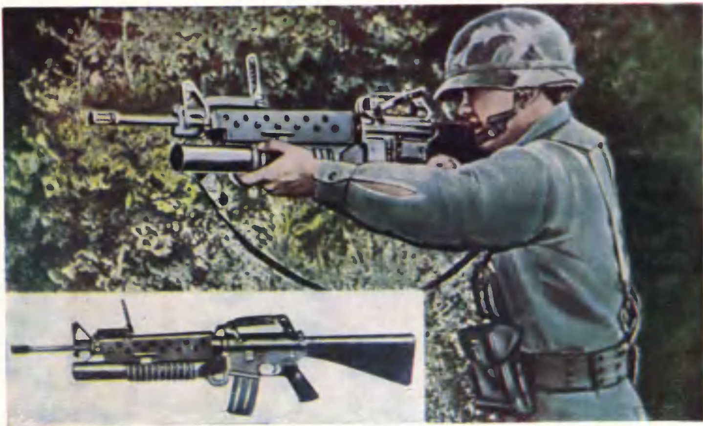
5,56-мм АВТОМАТИЧЕСКАЯ ВИНТОВКА М16А1. Состоит на вооружении сухопутных войск США. Вес без магазина 3,1 кг, длина 955 мм, темп стрельбы 850 выстр./мин, в магазин вмещается 20 патронов весом по 11,2 г (вес пули 3,5 г, заряда 1,62 г), начальная скорость пули 975 м/с. Из винтовки можно вести также стрельбу винтовочными гранатами типа «Энерга» (без дополнительных приспособлений) и 40-мм выстрелами с помощью укреплённого под стволом гранатомёта M203.
