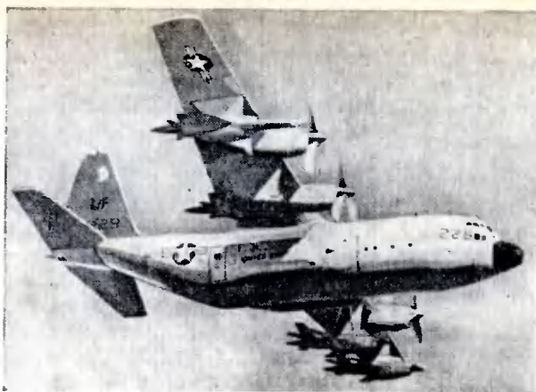
Рис. 3. Самолет-матка DC-130 несет два беспилотных самолета BQM-34F под правой консолью крыла и два BQM-34A под левой консолью крыла
